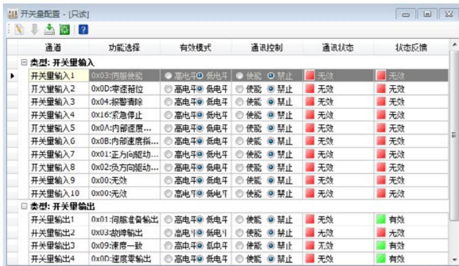
스위치 입력 및 출력은 단자 유효 논리 및 기능 할당을 직접 선택할 수 있습니다
